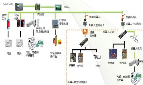
PLC 电气控制系统示意图
