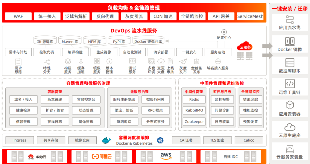
图 2: 技术中台架构图
