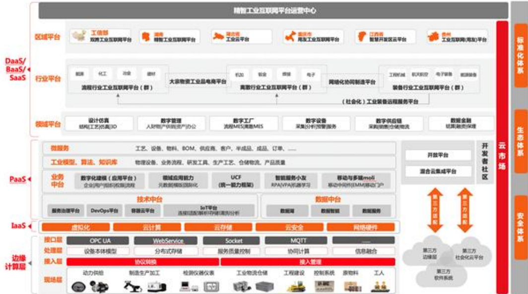
图 7：精智工业互联网平台总体架构
