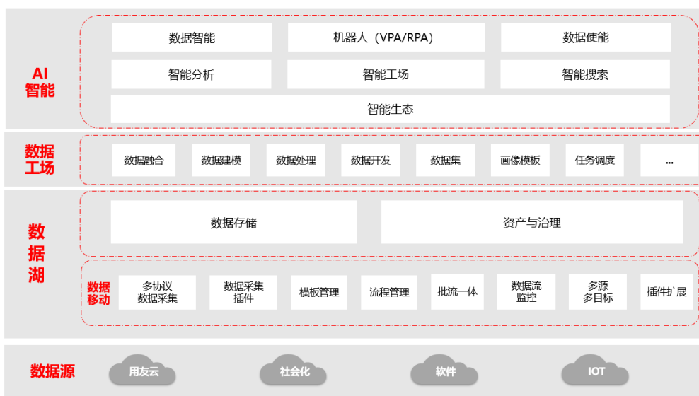
图 3：数据中台架构图
