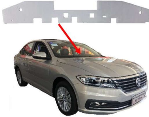
图：公司 ePTFE 膜复合吸音棉示意图
