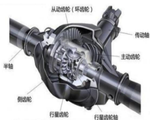
汽车差速器结构图
