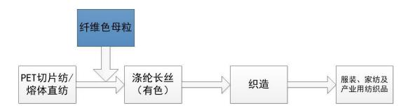
使用纤维母粒进行原液着色,可以省略大部分的染整工序,减少废气废水排放,大幅节省生产用水和化学品。
