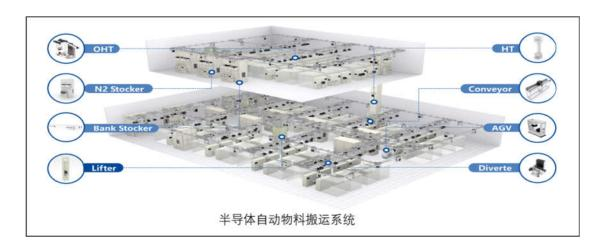
(3) 半导体物料管理控制系统项目: 物料管控系统(MCS) 是半导体工厂 AMHS 的核心控制系统,它是半导体制造中的关键核心软件,是一个在真正意义上的实现了半导体芯片全自动化无人搬送的系统。MCS 直接控制硬件设备,使得自动物料搬运系统(AMHS)得到充分的发挥,实现促进了半导体制造业技术的不断提高。主要应用领
