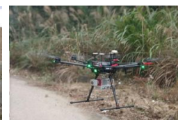
机载激光雷达测量 系统助力公路测量
