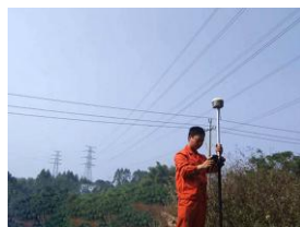
RTK 在电力勘测及塔基断面中的应用
