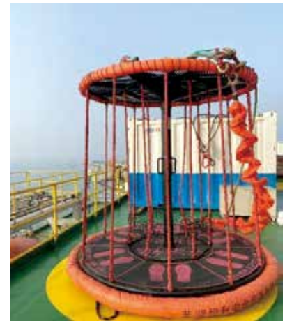
钻井事业部海上各一线生产单位全面配备硬质吊笼，在人员转运过程中，硬质吊笼支撑杆可以有效避免船体由于涌浪起伏导致的吊笼、人员摆动，提高平台应用船舶倒班上下平台时，吊人作业的安全性。
