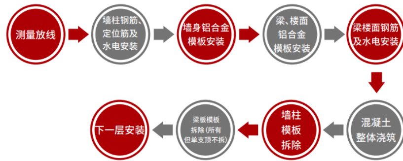
图注：铝模板拼装流程
