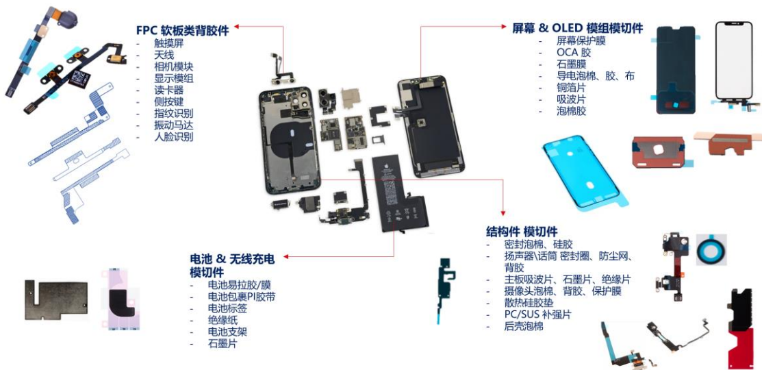
图：发行人功能性器件产品在智能手机中的应用示例
