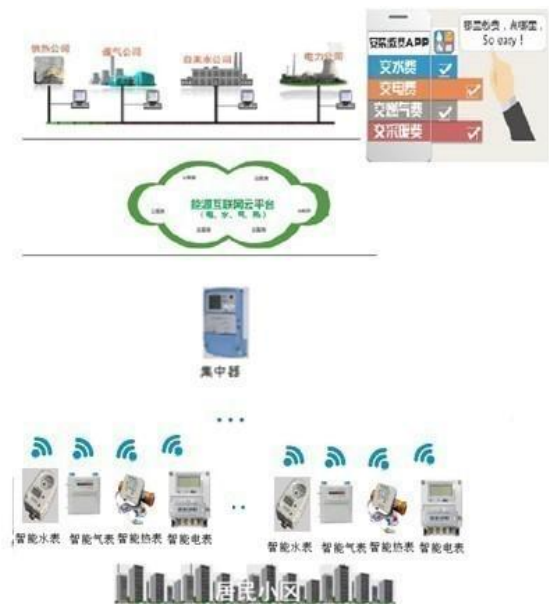
LORA物联网无线远程抄表系统
