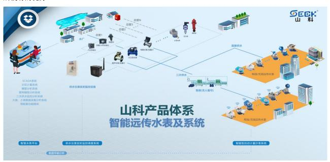
智能水表由计量传感器、智能基表及相关零配件构成,根据计量传感器原理不同,公司生产销售的智能水表最主要有如下五类:磁敏式脉冲智能水表及计量传感器、电感式脉冲智能水表及计量传感器、摄像直读智能水表及计量传感器、厚膜直读智能水表和光电直读智能水表。
