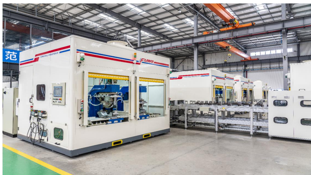
图：公司建造的机器人焊接工作站
