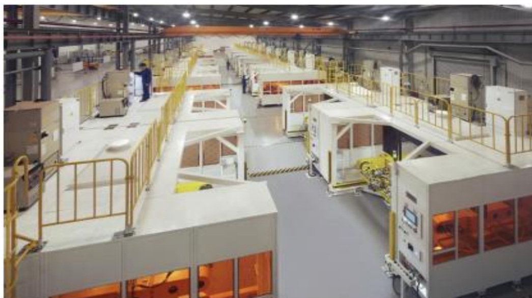
图：公司建造的摩托车焊装生产线
