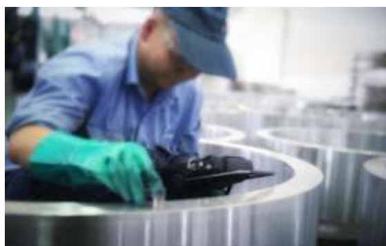
无损探伤检测
