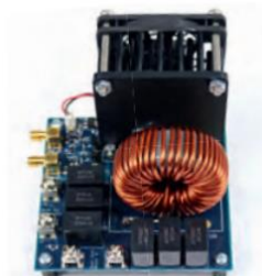
安世 GaN FET 的半桥电路示意
