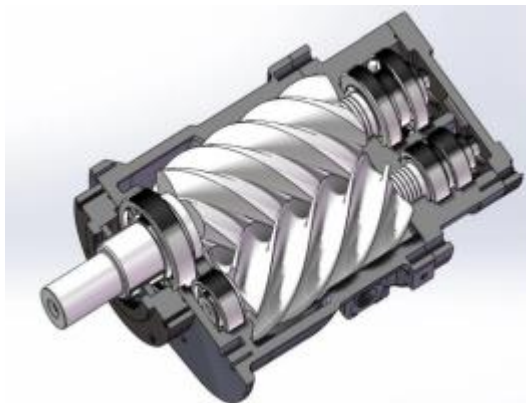
螺杆主机内部结构示意图
