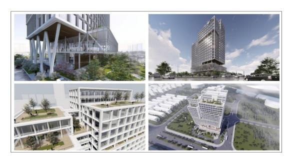
项目位于杭州市滨江区,建筑总高104米,含办公、展示、商业配套等功能业态。在平面功能布局方面,考虑到办公空间使用效率的优化,建筑师将核心筒设置于靠近建筑的北侧,通过缩小首层建筑的占地面积并架空悬挑部分楼层,增加更多的室外绿地面积。
