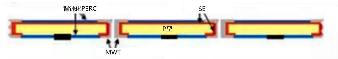
图：PERC+MWT+SE 电池设计原理
