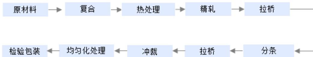
先将外购的原材料进行复合加工，后进行热处理、冷轧等工艺，之后再拉矫、冲裁，最后进行均匀化处理及检验包装。主要生产环节介绍如下：
