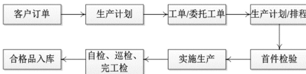
除“以销定产”外，由于公司割草机销售规模较大，而割草机底盘的生产周期相对较长，工序较复杂，公司为确保生产旺季的供货能力，通常结合预估订单，对割草机底盘进行适当的备货生产。
