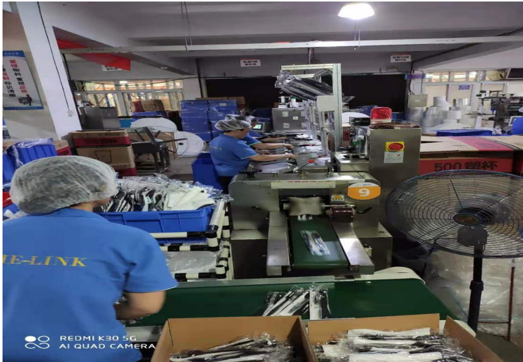
导入后包装线，结合多件模，仅需一台注塑机和一名装箱工人：
