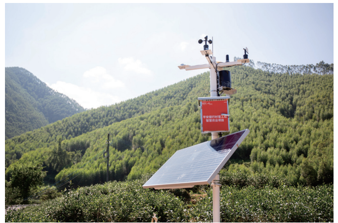
广东省河源市紫金县一处茶场内，平安智慧农业科技仪器连通“平安一号”卫星，随时监控土壤微量元素、空气和水质、设备记录和传输的信息，既促进农业生产效率，又保障了金融业务安全。
