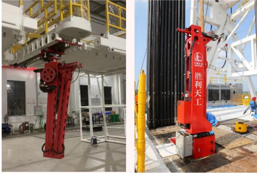
▲ “胜利天工” DREAM-II 钻井管柱自动化操作系统
