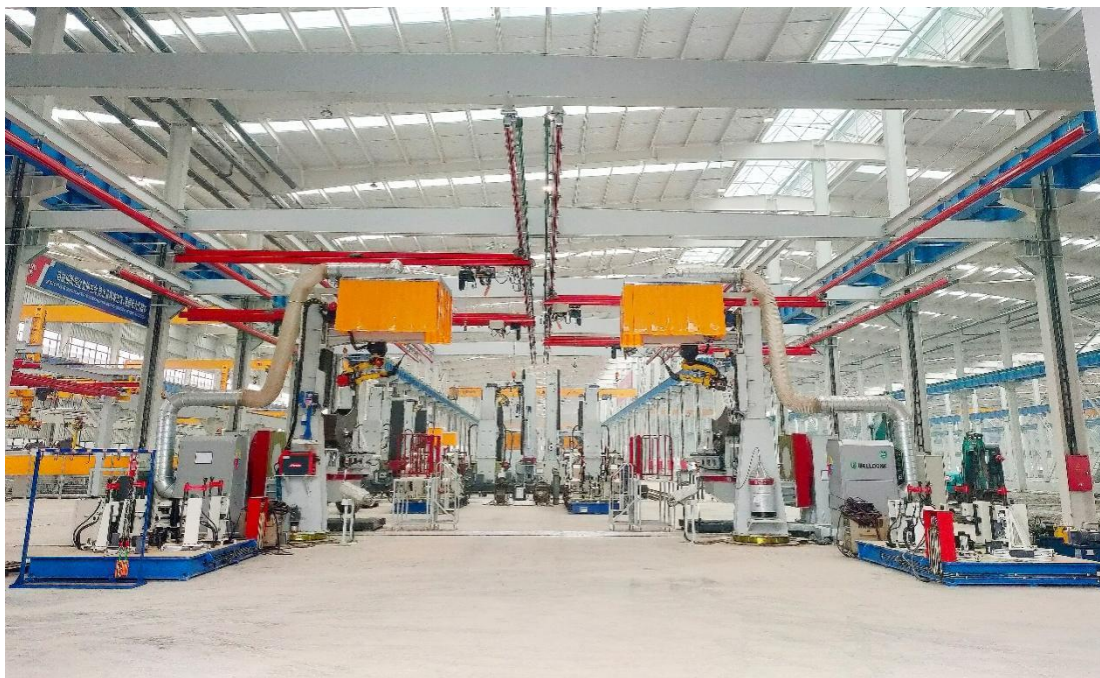
图：公司建造的工程机械行业焊装产线
