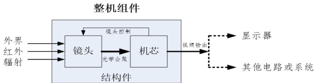
与独立的机芯产品不同，整机组件内的机芯通常还需要控制红外镜头，实现诸如光学变焦、视场切换、自动对焦等功能。整机组件的视频输出信号有两种用途：1) 输出标准视频信号，接到标准显示器上直接供人眼观察；2) 输出数字视频信号，作为其他部件的视频输入源，集成为复杂系统的一部分。
