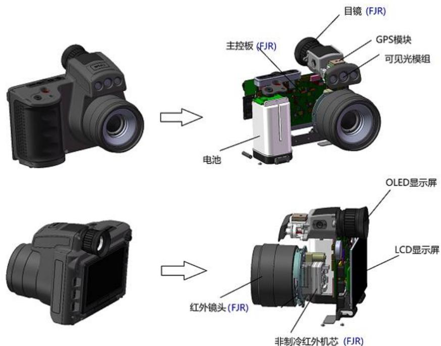
整机除了实现基本的热成像功能外，还针对特定应用具有一些专用功能，因此其硬件组成比整机组件更复杂，往往需要在机芯之外增加整机控制电路板（主控电路），统一管理包括机芯在内的所有硬件模块，运行整机软件，实现整机功能。整机的工作原理示意图如下：
