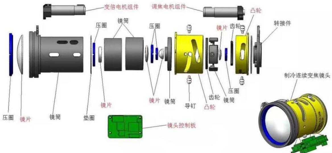
镜头通常需要多片光学镜片组合，并靠机械结构来保证这些光学镜片的位置，靠电路控制来
