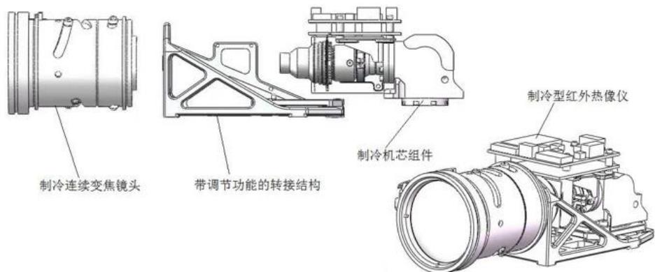
功能复杂一些的热像仪在机芯、镜头和结构件之外，还配有主控电路和若干功能模块（如可见光、北斗、显示屏等），因此也具备更为复杂的功能（如多光谱切换成像或融合成像、红外测温、坐标定位、拍照/录像/回放等），公司将这类热像仪通称为热像仪整机，简称整机。整机构分解示意图如下：
