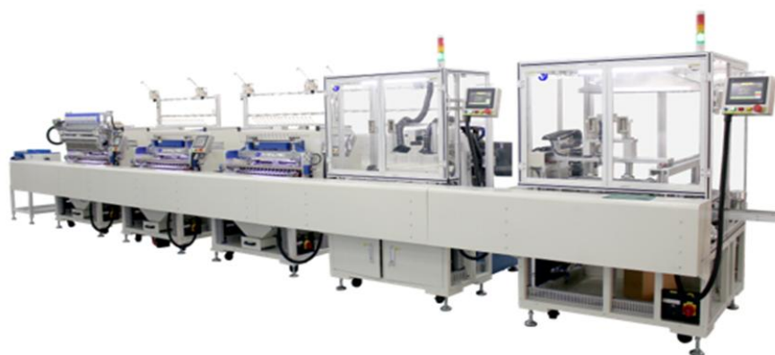
全自动变压器流水线
