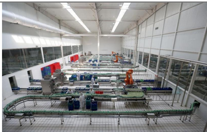
生产车间采用自然光照明，减少用电量
