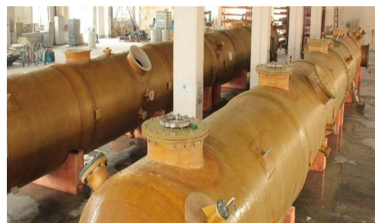
以 ECTFE +FRP 制成的盐酸反应塔 (尺寸 D1.8xH25m)
