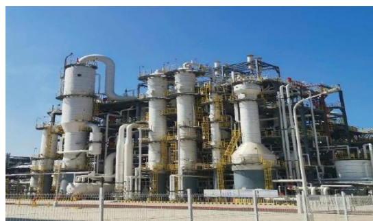
以 FEP 和 FRP 制成的盐酸吸收塔 (尺寸 D2.4xH18m)
