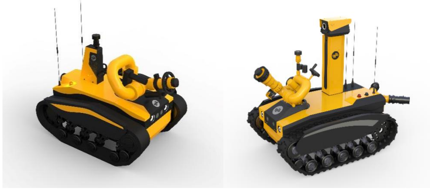
消防灭火机器人
