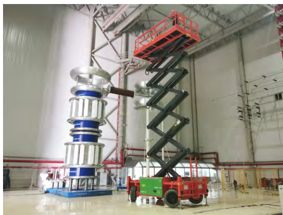
全系列10款高米数电动剪叉产品,高度覆盖18米至32米,载重750kg-1000kg,全高度行走,四驱四转,是行业高度最高、载重最大、覆盖最全的电动电剪叉式高空作业平台。
