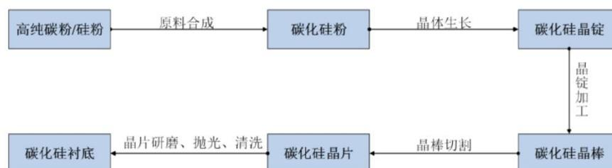
原料合成步骤包括：将高纯的硅粉+碳粉按配方混合，在 2,000℃以上的高温
