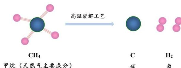
如上图所示，碳粉作为公司气相沉积工艺副产品，基于公司的工艺特点具有纯度高、成本低等天然优势。此外，公司在高温热处理工艺方面具有丰富的技术积累，可为高纯碳化硅粉的合成提供高纯度的碳粉原料、成熟的高温热处理工艺。
