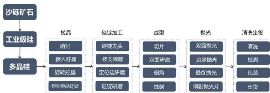
与光伏领域相似，公司的碳/碳复合材料坩埚、导流筒、保温筒等产品应用于“拉晶”阶段的单晶硅拉制炉热场系统。
