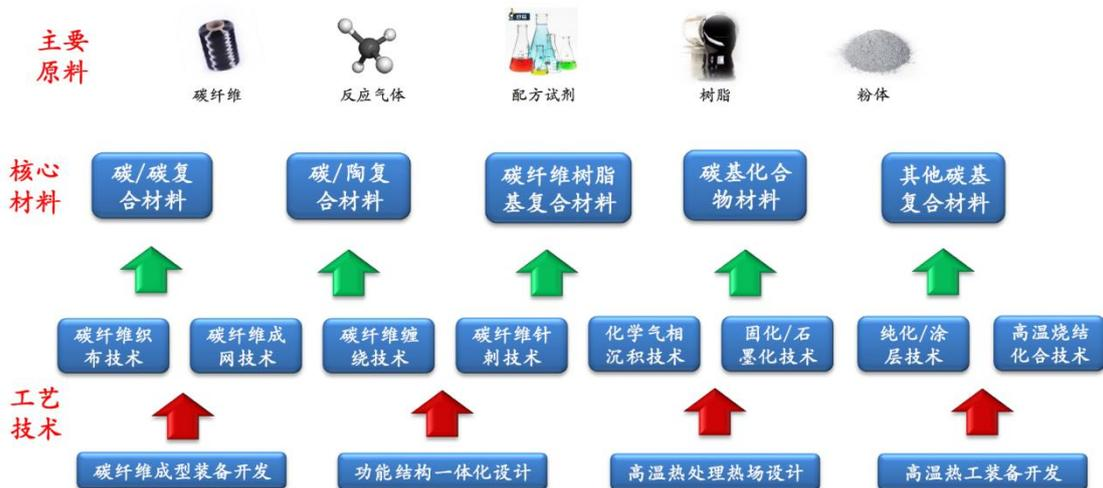
由上图可知，先进碳基复合材料领域内，不同材料应用的原材料、技术和工艺具有通用性。各类碳基复合材料所需的材料主要包括预制体制备类(碳纤维等)、沉积物料类(气体、树脂、粉体等)，预制体制备技术主要包括碳纤维织布、缠绕、针刺等通用型技术，主要沉积工艺包括气相沉积、浸渍、高温烧结等，并通
