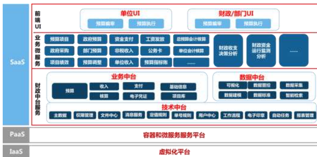
图：财政中台项目建设方案架构图
