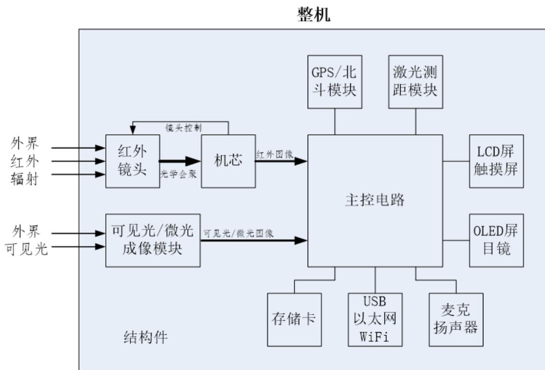
整机的红外图像来自机芯的输出信号，整机的成像性能主要取决于机芯和镜头的性能。整机的控制指挥中心是主控电路，包括机芯和镜头在内的其他硬件都是整机里的分立功能模块，在主控电路的调度下各自负责一部分功能。主控电路是典型的嵌入式系统平台，且往往是多处理器组合的架构，以实现整机较为复杂的功能。
