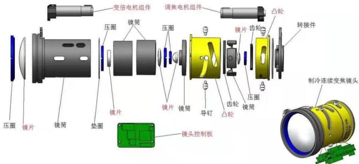
镜头通常需要多片光学镜片组合，并靠机械结构来保证这些光学镜片的位置，靠电路控制来实现光学镜片工作中的移动，同时需满足一定的环境适应性要求（即在高/低温/机械振动/冲击等环境下仍能正常工作），因此，红外光学镜头是由光学、机械、电子集成，具备独立功能的产品。
