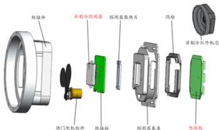
机芯中的探测器接收外界的电磁辐射信号，将其转换为电信号输出。硬件电路采集探测器输出的信号并进行处理（包括信号放大、模数转换、图像处理、视频编码等），最终输出标准格式的电子视频图像。探测器作为一种光电器件，其自身无法独立工作，需要依靠机芯的硬件电路才能正常工作。机芯的硬件电路一般分为三部分：探测器驱动及信号采集电路，对探测器进行驱动并采集探测器输出的电信号；信号处理电路，对探测器输出的信号进行图像降噪、图像增强、视频编码等处理；接口电路，实现机芯的电源管理和对外接口。信号处理电路的嵌入式处理器上运行机芯的软件，机芯软件负责管理调度硬件电路的所有部件（包括探测器），进行图像数据处理，实现成像功能。结构件将探测器及硬件电路安装在一起，在保证结构强度的同时实现探测器和硬件电路的散热。
