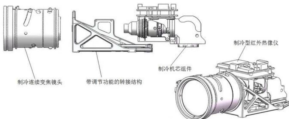
功能复杂一些的热像仪在机芯、镜头和结构件之外，还配有主控电路和若干功能模块（如可见光、北斗、显示屏等），因此也具备更为复杂的功能（如多光谱切换成像或融合成像、红外测温、坐标定位、拍照/录像/回放等），公司将这类热像仪通称为热像仪整机，简称整机。整机构成分解示意图如下：
