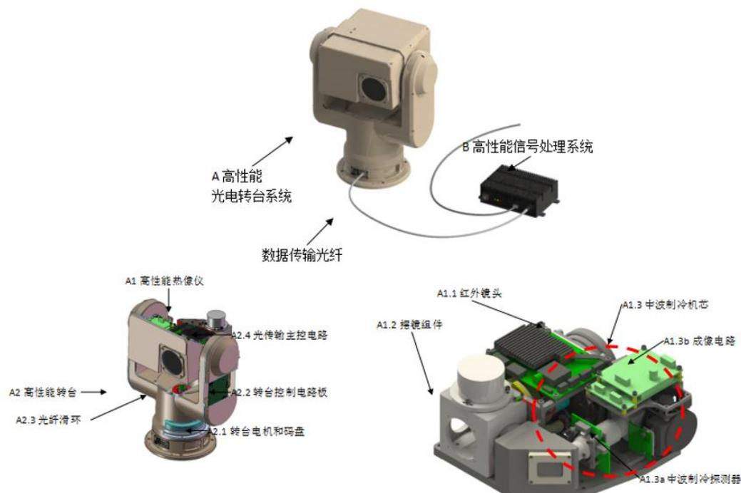
红外全景雷达工作时，高性能转台以高速高精度水平匀速转动，内部的热像仪整机组件与摆镜组件协同工作，实现高速高精度的旋转补偿、同步曝光、采集成像。热像仪的图像通过转台内部的光传输模块转换为光信号，由光纤传输到转台外的高性能信号处理系统。高性能信号处理系统通过光传输模块将光信号转换回原始图像信息，送入数字信号模块、人工智能处理模块中，进行复杂的信号处理和人工智能算法处理，将得到的处理结果通过网络传输到后端计算机。后端计算机上运行的用户控制软件接收处理结果，对其进行分类，并以图形化界面将三千多万像素的全景图像和处理结果实时展现在显示屏上，并完成记录、回放、检索等高级功能。
