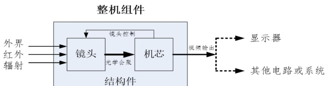
与独立的机芯产品不同，整机组件内的机芯通常还需要控制红外镜头，实现诸如光学变焦、视场切换、自动对焦等功能。整机组件的视频输出信号有两种用途：1) 输出标准视频信号，接到标准显示器上直接供人眼观察；2) 输出数字视频信号，作为其他部件的视频输入源，集成为复杂系统的一部分。
