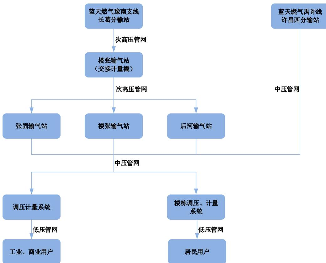
(2) 燃气安装工程业务流程图
