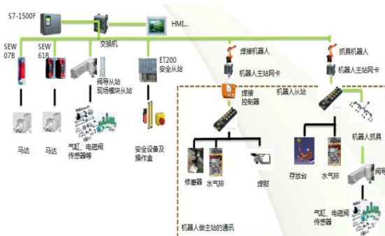
PLC 电气控制系统示意图
