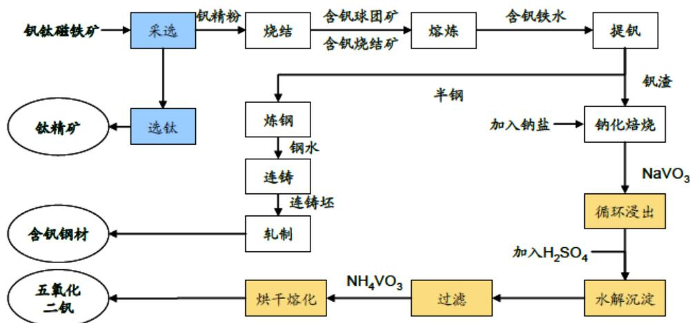
注：□表示含钒钢材生产 □表示钛精矿提取过程 □表示氧化钒提取过程 ○表示产品
