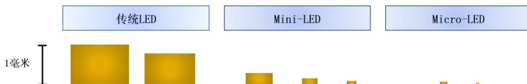
不同类型 LED 芯片尺寸比较示意图
