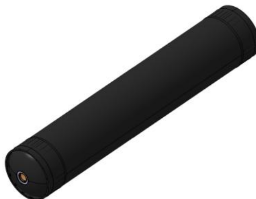
某火箭一级发动机复合材料壳体
