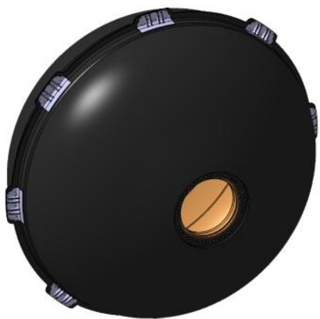
某火箭三级发动机复合材料壳体
