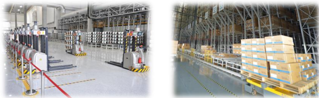
AGV 搬运系统
