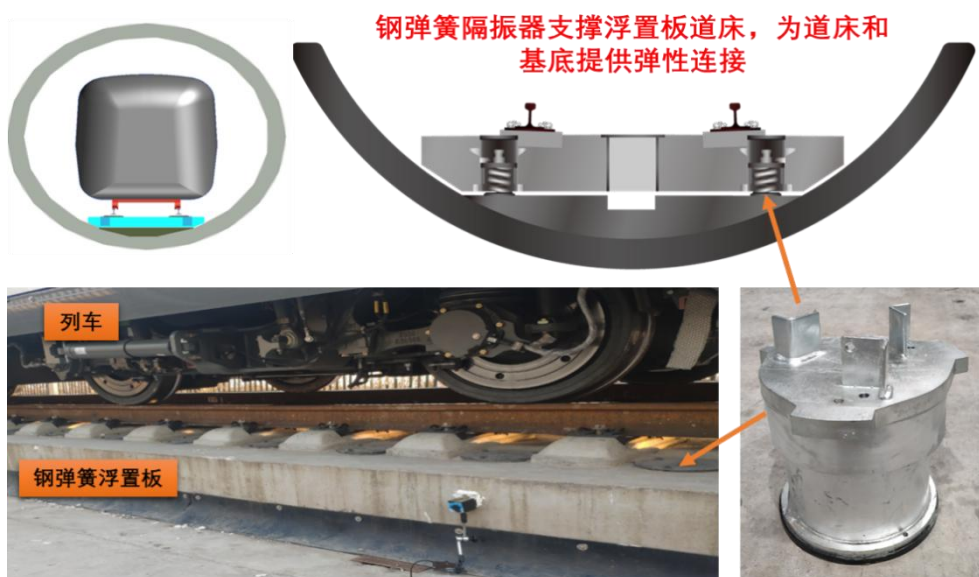
钢弹簧浮置板道床示意图
