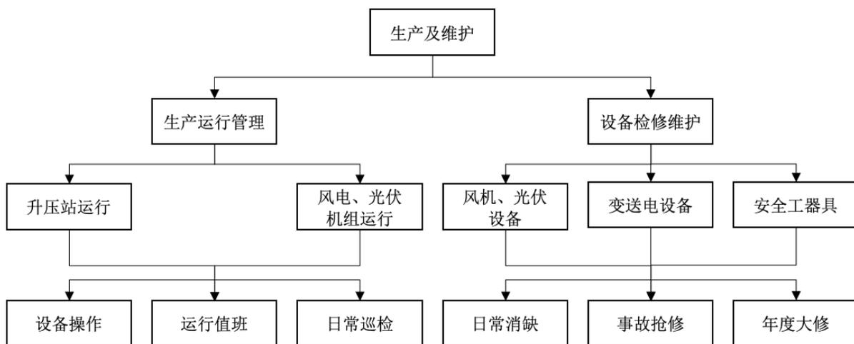
生产及维护环节的管理主体为项目公司，项目公司根据各电场设备情况、风光资源变化情况、电网检修计划等，制定详细的生产及维护规划，在小风季和电网检修时加强发电设备的检修和保养，确保设备在大风季具备良好工况，以提高发电效率，提高利用小时数。
