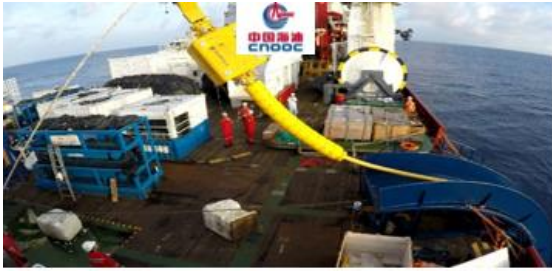
国产化大长度海洋脐带缆 文昌9-2/9-3/10-3气田群开发项目 水下生产系统脐带缆 水深：200m
