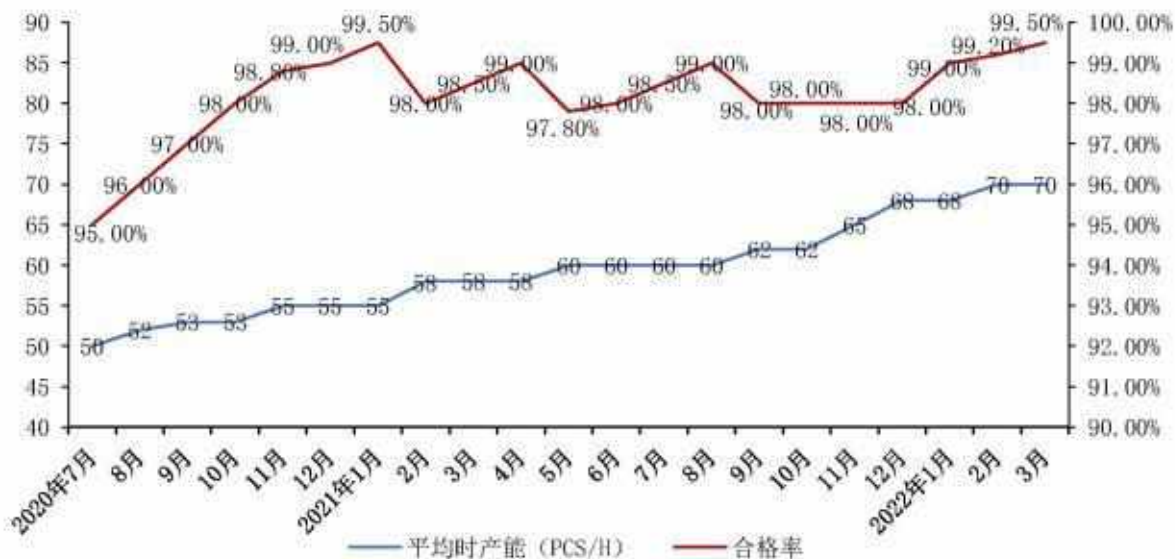
2020年7月至2022年3月蝴蝶式绕法全自动电源电感绕线机升级优化过程
