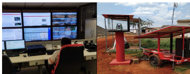
洛钼巴西对尾矿库安装了微震监测系统，在线监控尾矿库运行全过程结构位移。
