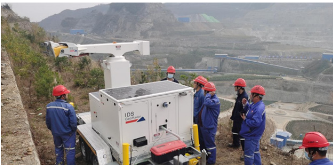
中国矿区矿山公司采用IBIS ArcSAR 全方位边坡监测雷达，与原有边坡点监测系统相互补充，以提升边坡安全管理与预警水平。
