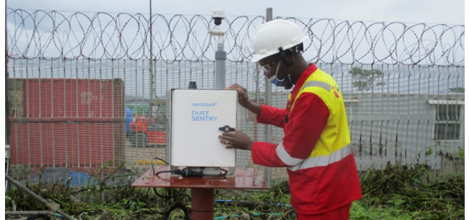
2022年TFM升级了现场PM10的监测设备，实现了自动监测并实时联网上传。
