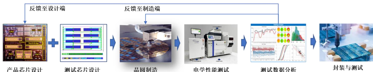
通过电性检测提升成品率的一般流程图
