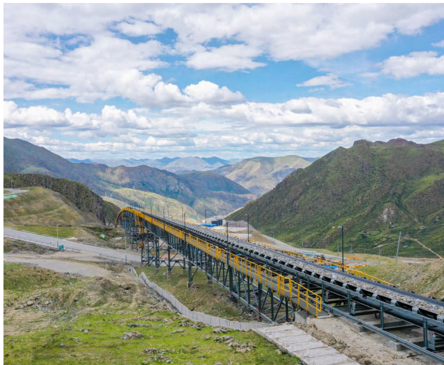
巨龙铜业的长距离下坡回流充电式运矿皮带
