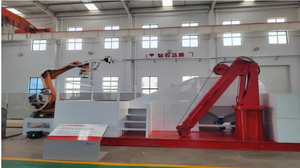
▲“胜利天工” 钻井液智能自动加料装置
