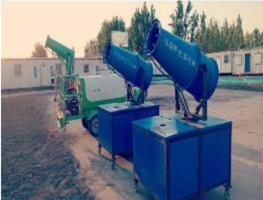
▲ 井场洒水降尘
