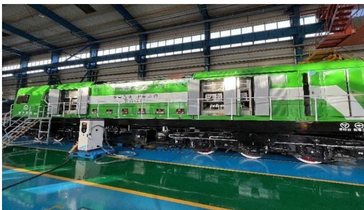
图：改造中的电力驱动机车
