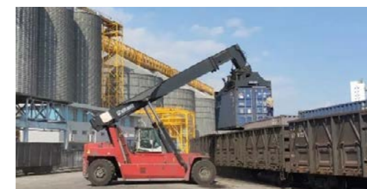
散改集运输吊装现场
