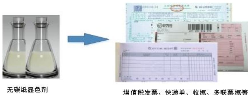
如下图：通常多层无碳纸正面涂有无碳纸显色剂（公司产品），纸背面涂有无色染料微胶囊，在笔尖、打印针等压力的作用下，无色染料微胶囊破裂，释放出无色染料与无碳纸显色剂接触反应达到显色的功能。
